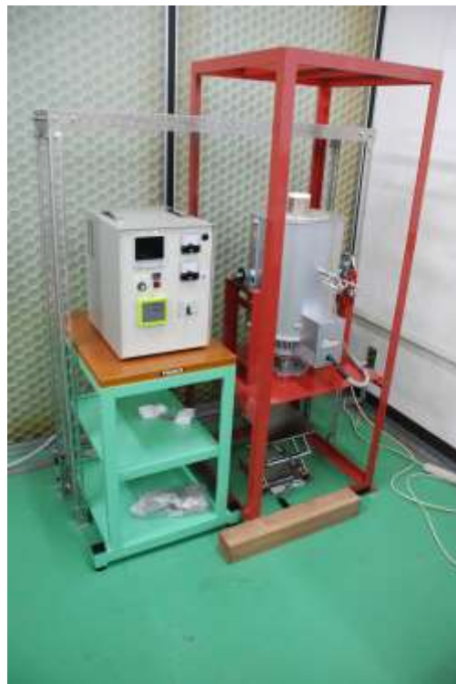
図11 マグマ粘性測定装置
